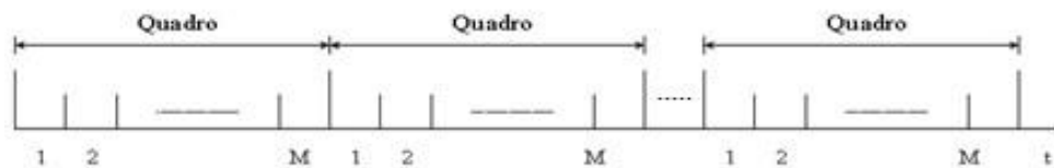
Figura 2. Estrutura de quadros do TDMA.
