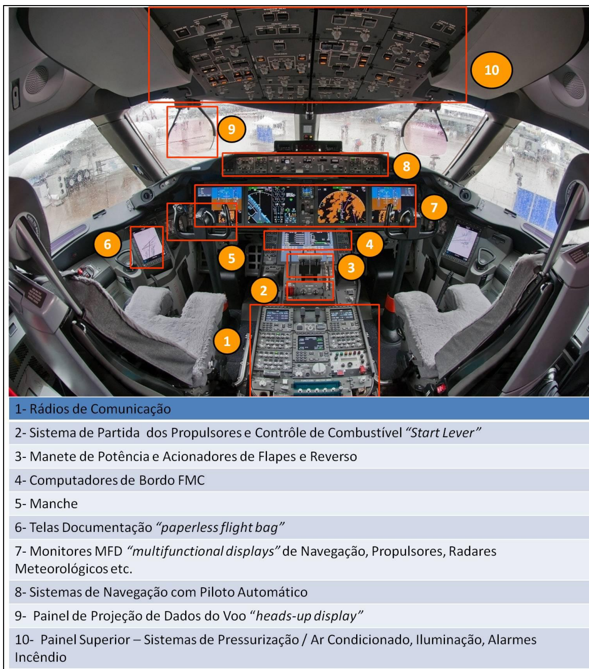
Figura 33: Dispositivos da cabine de comando – Instrumentos "Glass-Cockpit" adaptado fonte web: http://upload.wikimedia.org/wikipedia/commons/4/44/Boeing_787-8_N787BA_cockpit.jpg
