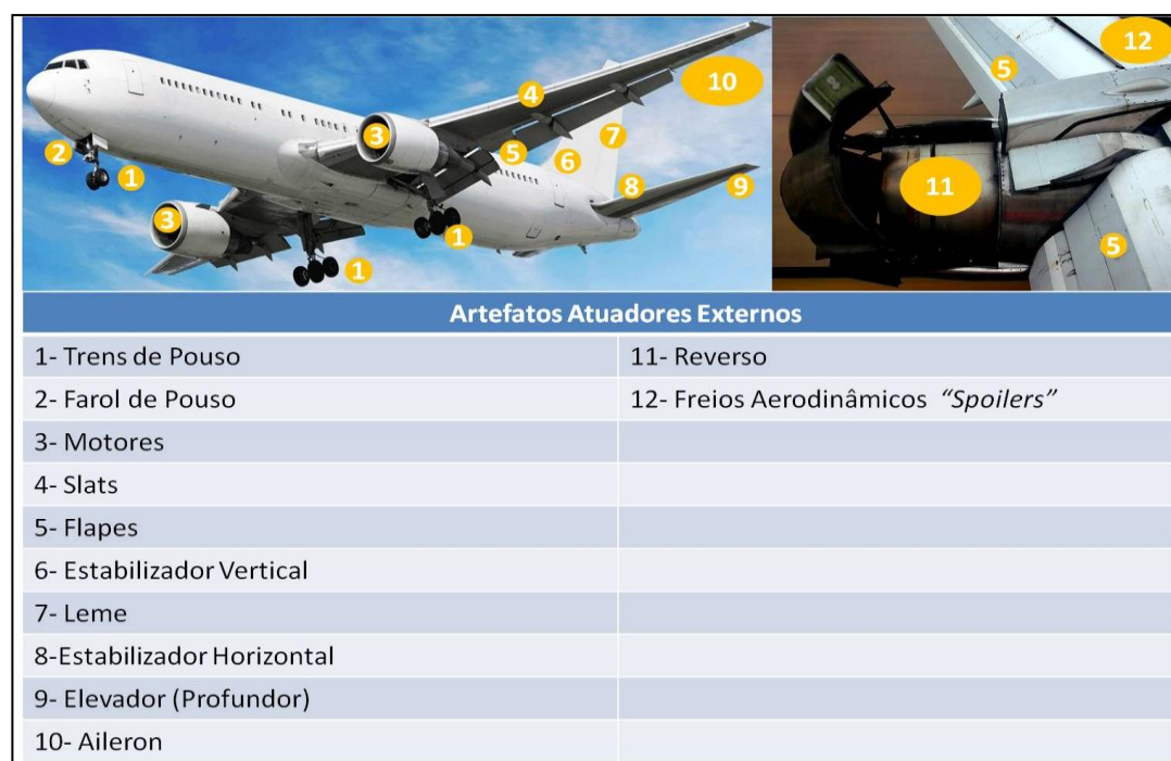
Figura 31: Artefatos atuadores externos adaptado fonte web, a esquerda: http://s3.amazonaws.com/rapgenius/filepicker%2FjDPepkMLTcGWT2K88rAg_plane.jpg a direita: http://commons.wikimedia.org/wiki/File: Boeing_737-200_thrust_reverser.jpg
