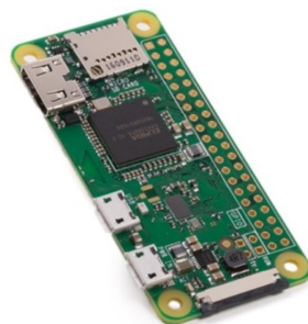
Figura 54- Microcomputador RaspberryPi Zero W, aplicado na versão CX-Pesquisa, do projeto de hardware doPlantVoice.
