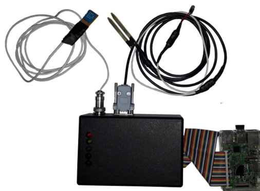
Figura 43- Circuito em fenolite do PlantVoiceCX Beta acondicionado em uma caixa protetora.
