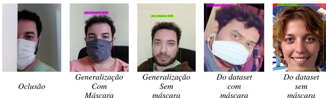
Figura 21 – Inferência YOLOv3 base 80-20.
