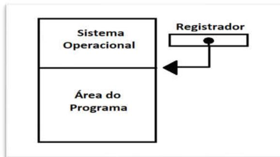
**Figura 3: Representação esquemática da técnica de Alocação Contígua Simples (Fonte: Adaptada de Machado e Maia, 2013)**
