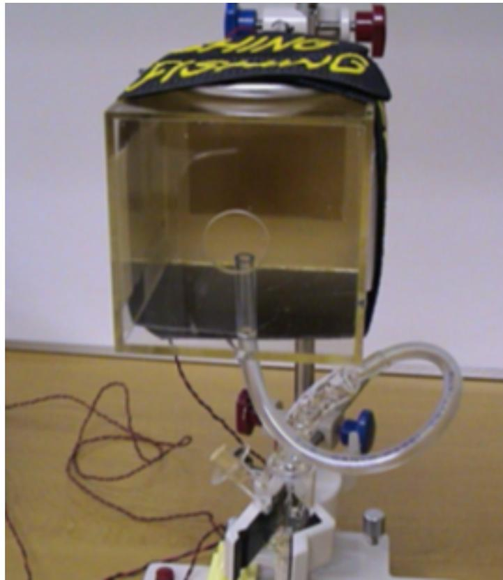
Figura 4 – Dispositivo olfativo gerador de aroma do tipo canhão (YANAGIDA et al., 2003)
