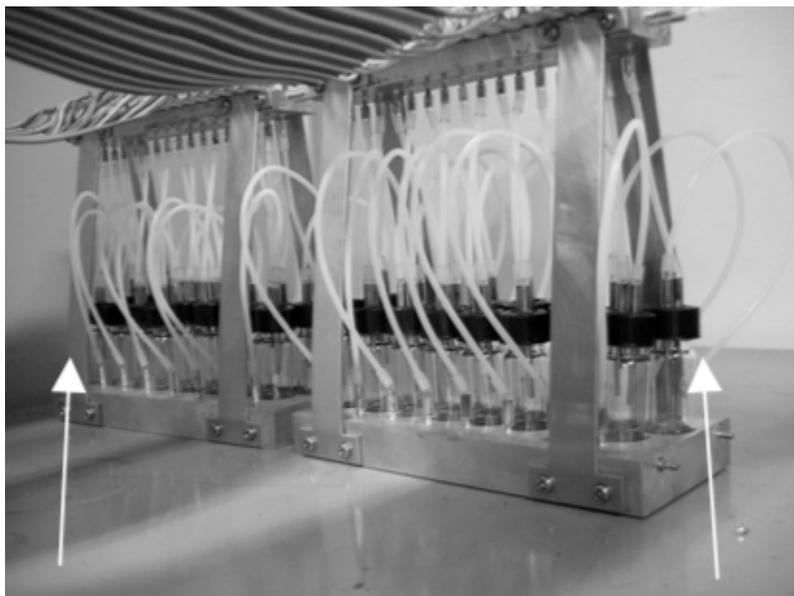
**Figura 8 – Autosampler: sistema integrado de difusão com mistura de diversos tipos de aromas (NAKAMOTO; MINH, 2007)**
