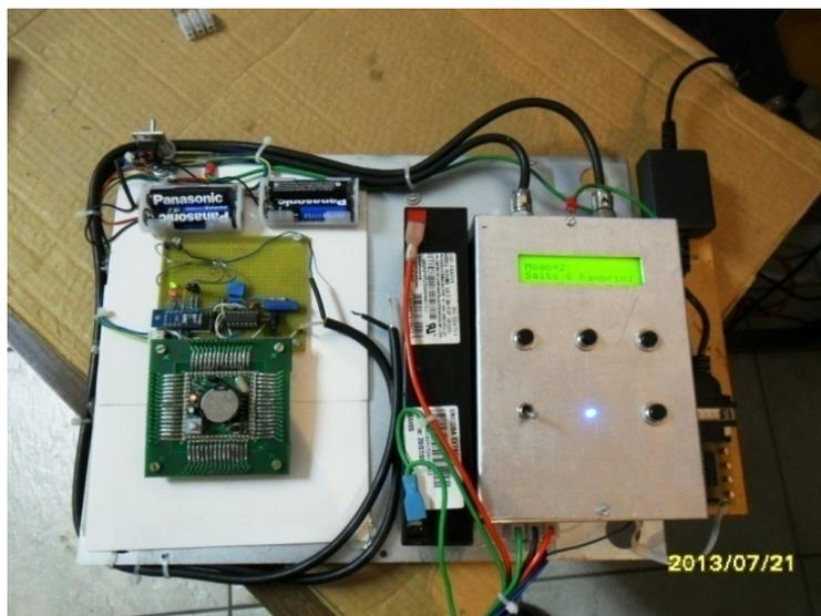
Figura 6.11: Conversor AD implementado, juntamente com o pré-amplificador e filtros, à esquerda.
