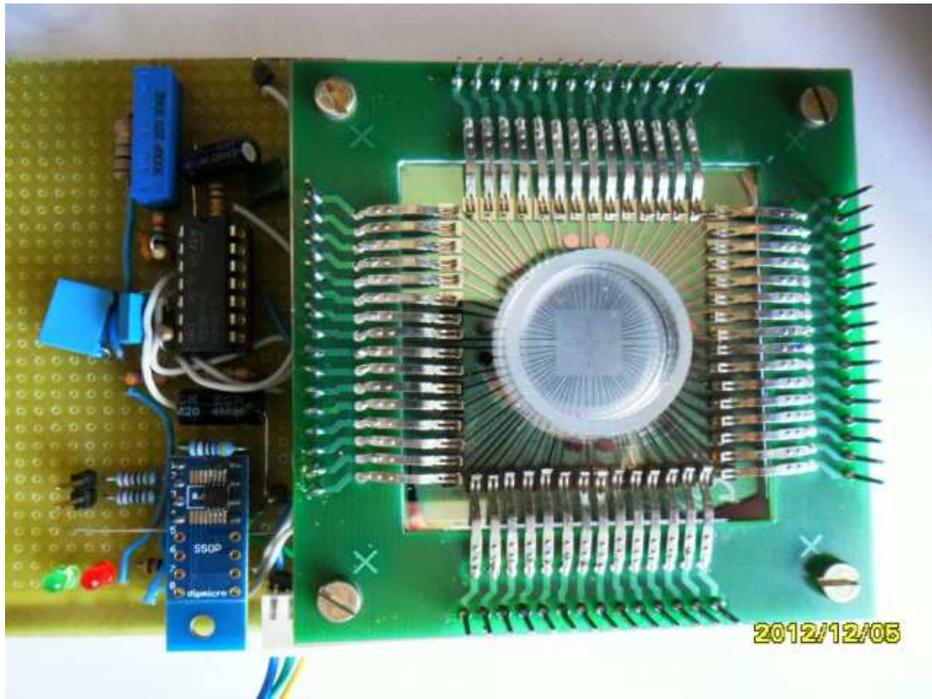
Figura A. 2: Soquete elétrico acoplado à MEA padrão. À esquerda, protótipo de dois canais do amplificador *headstage*.
