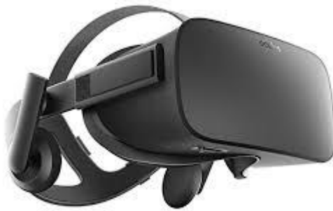
Figura 12: Exemplo de HMD desenvolvido pela empresa Oculus (Fonte: https://www.oculus.com )
