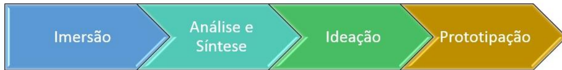
Figura 6 - Etapas do processo de Design Thinking (adaptado de Vianna et al, 2012 - p.18).
