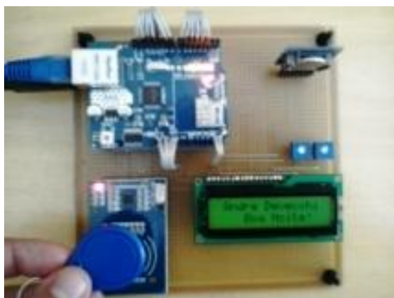
Figura 5. Protótipo do Sistema Embarcado realizando a leitura da tag de identificação.
